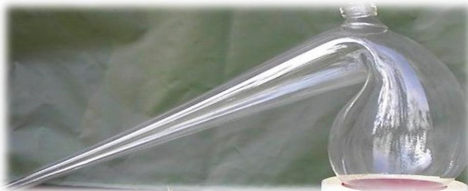
در آزمایشگاه شیمی، قرع یک ظرف شیشه‌ای مورد استفاده برای تقطیر یا تقطیر مواد خشک است. قرع از یک ظرف کروی با دهانه‌ای طولانی رو به پایین تشکیل شده است. دهانه آن به عنوان یک کندانسور عمل می‌کند و اجازه می‌دهد بخار متراکم شود.
