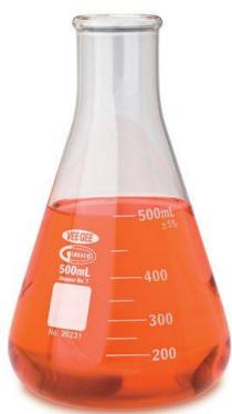
به آلمانی Erlenmeyer : ارنلمایر نوعی ظرف آزمایشگاهی مخروطی شکل است که عموماً در جهت جوشاندن مایعات آزمایشگاهی و جداسازی گازها به کار می‌رود. نام آن از نام مخترع آن ریچارد ارنلمایر شیمی‌دان آلمانی گرفته شده است و چون دهانه اش باریک است برای مخلوط کردن مایعات نیز به کار می‌رود .
