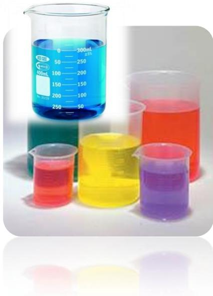
بشرها ممکن است از شیشه (غلب پیرکس) یا پلاستیک ساخته شده باشند. بشرهایی که برای نگهداری مواد خورنده استفاده می‌شوند باید از مواد مقاوم به خوردشدن مانند تفلون ساخته شده باشند.
