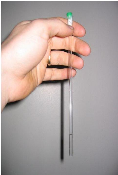
به انگلیسی NMR tube : یک وسیله آزمایشگاهی است که به شکل یک لوله شیشه‌ای باریک است که برای قرار دادن نمونه در دستگاه اسپکتروسکوپ ان ام آر استفاده می‌شود. این لوله‌ها معمولاً در قطر ۵ میلی‌متر ساخته می‌شوند اما در قطر ۳ میلی‌متر و ۱۰ میلی‌متر نیز موجود است.
