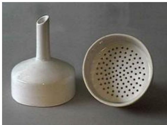
یکی از وسائل آزمایشگاهی است که برای تصفیه و خالص سازی مواد به وسیله نیروی مکش، به کار برده می‌شود. این قیف معمولاً از پرسلان «چینی» درست شده ولی نوع
