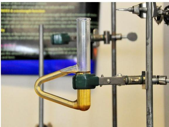
ویژگی مهم این ابزار ایجاد یک حمام روغن یا آب با دمای تقریباً ثابت است به این ترتیب که با حرارت دادن ملایم به دسته لوله یک جریان همرفت ایجاد می‌شود که باعث ثابت ماندن دما در کل مایع می‌شود
