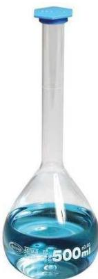
به انگلیسی Volumetric flask : یکی از ابزارهای آزمایشگاهی می‌باشد که برای ساخت محلولها با غلظت معین از آن استفاده می‌شود. این نوع بالن دارای یک گردن بلند است که بر روی آن خط نشانه‌ای قرار دارد. بالنهای حجمی دقیق بالایی داشته و فقط می‌توان حجم نوشته شده روی آن را به کمک آن از محلول حجم سنجی کرد. برای این نوع بالن در پوش پلاستیکی طراحی شده است تا بتوان در هنگام محلول سازی آن را به راحتی تکان داد.
