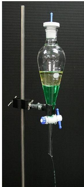
به انگلیسی Separatory funnel : یکی از ابزار آزمایشگاهی است که مایعات را بر اساس چگالی از هم جدا می‌کند مثلاً اگر مخلوط روغن و آب را در مخزن این دستگاه برشیزیم بر حسب چگالی مواد در داخل این ظرف تفکیک می‌شود اگر شیر زیر ظرف را باز کنیم مایعی که دارای چگالی بالاست در زیر قرار گرفته و از دستگاه خارج می‌گردد تا اینکه به مرز جدایی مایعات (روغن و آب) برسد، در چنین حشیر را می‌بندیم و دستگاه با موفقیت دو مایع مخلوط را از هم جدا می‌کند.
