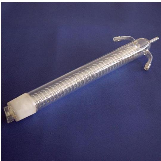
به انگلیسی (Condenser) یکی از ابزارهای آزمایشگاهی می‌باشد که به منظور سرد کردن بخارات و تبدیل آن‌ها به مایع استفاده می‌شود. این وسیله بیشتر در فرایند تقطیر و برای سرد کردن بخارات حاصل از تقطیر مخلوط چند مایع به منظور جداسازی آن‌ها به کار می‌رود.
