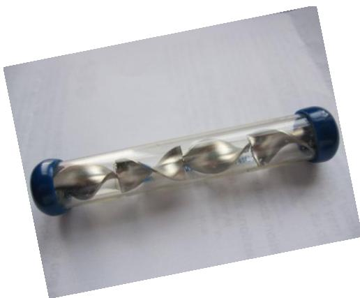
به انگلیسی Static mixer : ابزاری به منظور همزدن و مخلوط کردن مواد سیال است. از این ابزار در ابعاد مختلف به منظور همزدن مایعات و گازها استفاده می‌شود. ساختار کلی این ابزار شامل یک لوله می‌باشد که داخل آن یک پره مارپیچی قرار دارد که با چرخش این پره سیالات ورودی مخلوط می‌شوند. معمولاً این وسیله را از موادی چون PVDF، فولاد ضدزنگ، پلی‌پروپیلن و تفلون می‌سازند.
