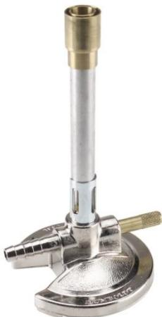
به انگلیسی Bunsen burner : یکی از ابزارهای آزمایشگاهی است که به عنوان منبع تولید حرارت و انرژی گرمایی در آزمایشگاهها از آن استفاده می‌شود. این وسیله به افتخار روبرت بونزن به آلمانی Robert Bunsen : شیمیدان آلمانی نامگذاری شده است در این وسیله معمولاً از گاز شهری که حاوی هیدروکربن متان است یا گاز کپسول که از هیدروکربنهای پروپان و بوتان تشکیل شده، به عنوان سوخت استفاده می‌شود
